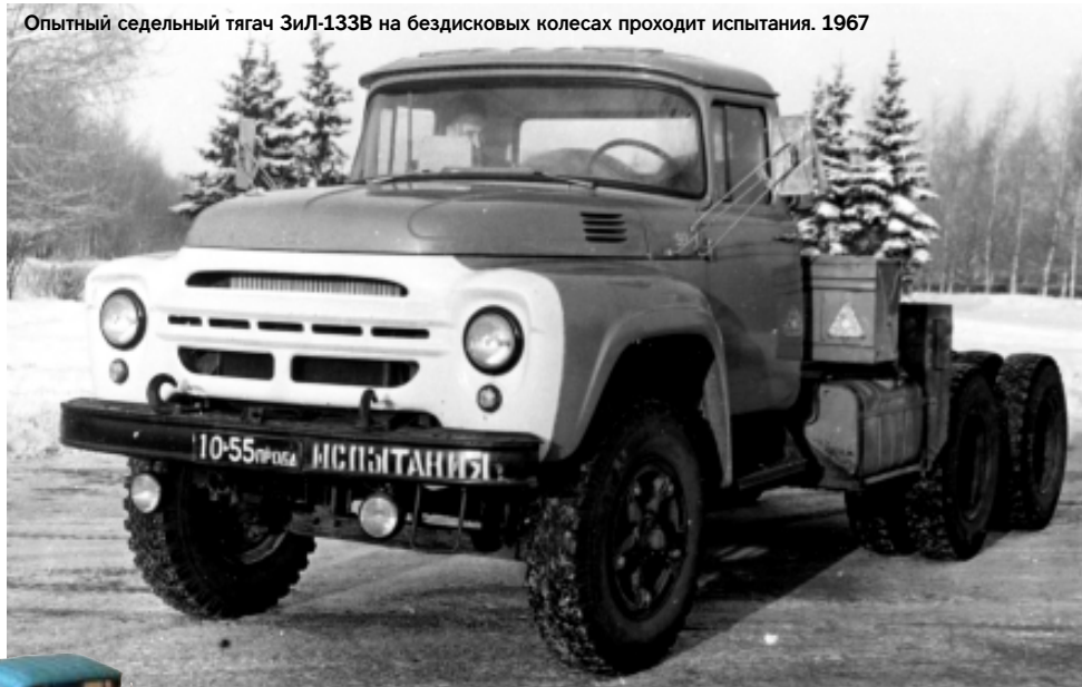
Опытный седельный тягач ЗиЛ-133В на бездисковых колесах проходит испытания. 1967
