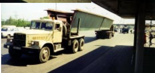
«Тяни-Толкай! конца XX в. Так перевозили фермы для эстакад на строительстве МКАД
