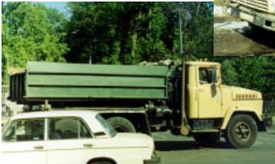
КраЗ-самосвал с двух(трех?)сторонней разгрузкой
